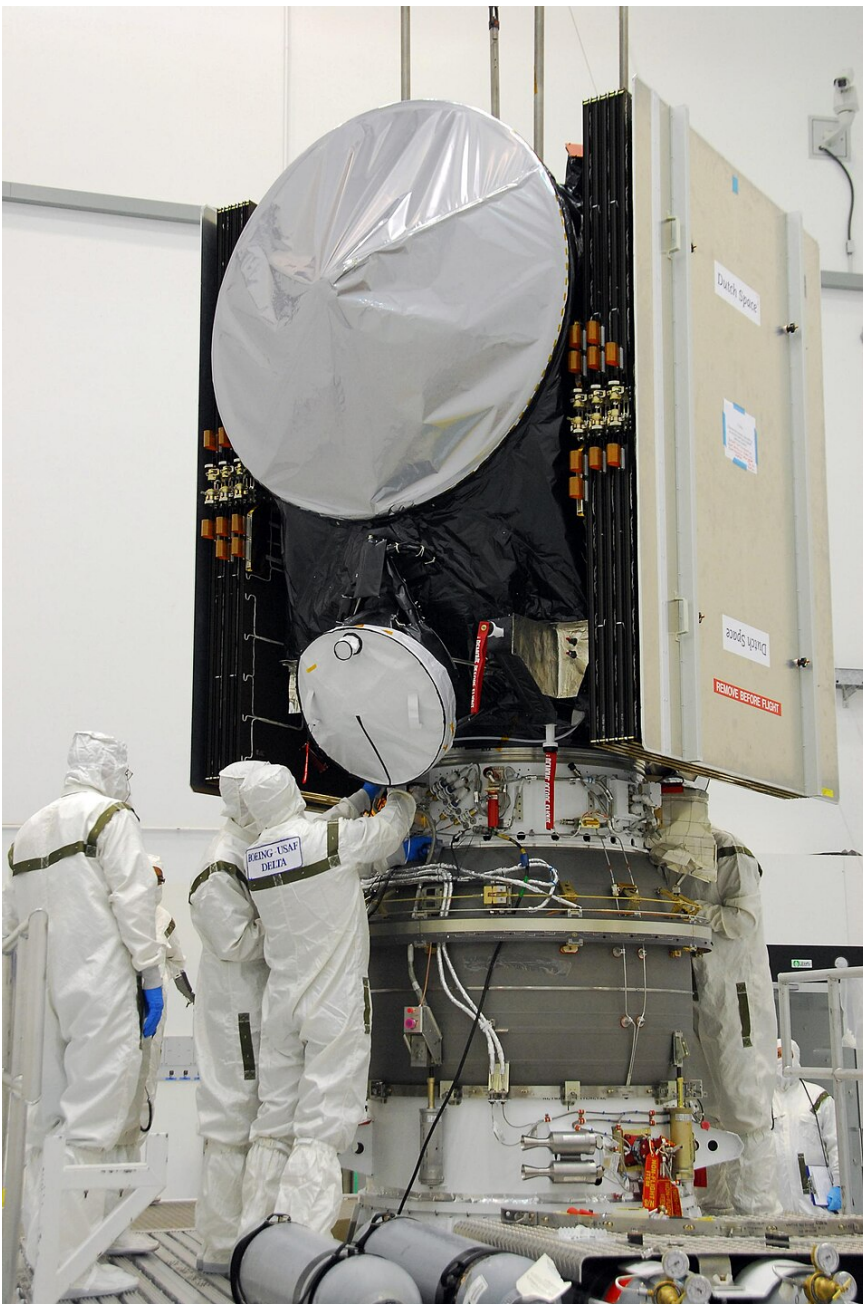
Dawn en cours d'installation sur le lanceur : les panneaux solaires sont en position repliée, on distingue l'antenne grand gain et en bas la tuyère d'un des trois moteurs ioniques. (Wikipédia)
